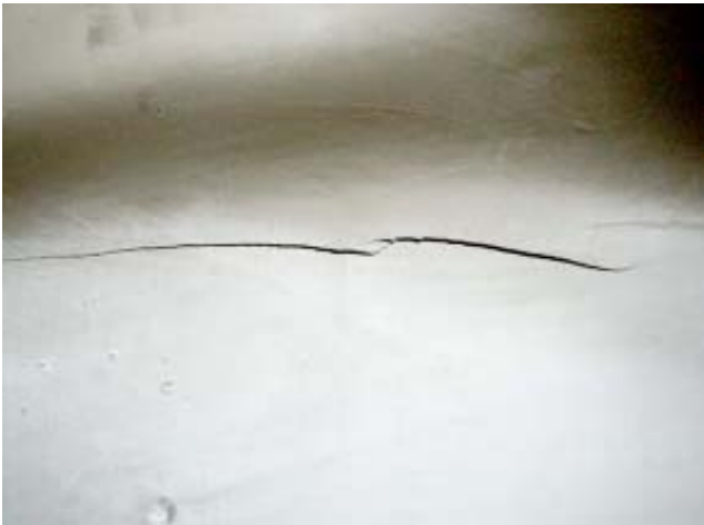
แผลแตกของชั้นงานเปียกที่ปล่อยให้แห้งในแบบนานเกิน หรือแบบหล่อแห้งเกิน
