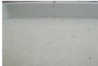
ภาพตำหนิรอยร้าวและจุดเหล็กที่ผิวชิ้นงาน
