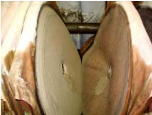
แผ่น Cake ที่ได้จากการทำ Filter press
