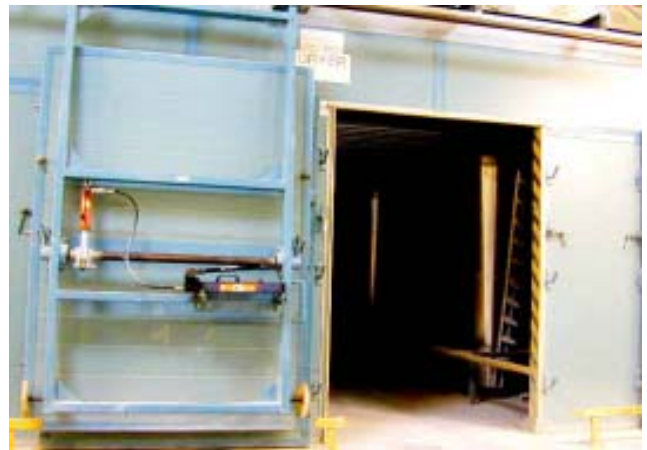
ห้องอบแบบแห้งเร็วโดยใช้อุณหภูมิสูง และควบคุมความชื้นได้
