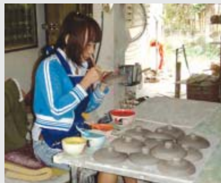
ภาพที่ 4 การเขียนลวดลาย บนชิ้นงานเซรามิกที่อาศัยทักษะ ของพนักงานที่มีประสบการณ์
